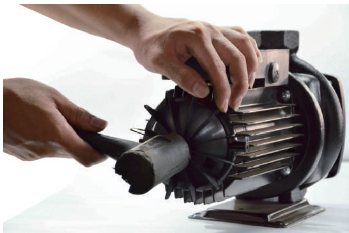
10. lépés gumikalapáccsal kocogtasd vissza a ventilátor lapátot
