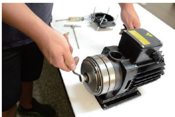
9. lépés: tegye rá a záróanyát, fogja meg az univerzális fogót, tekerje a villáskulccsal a záróanyát.
