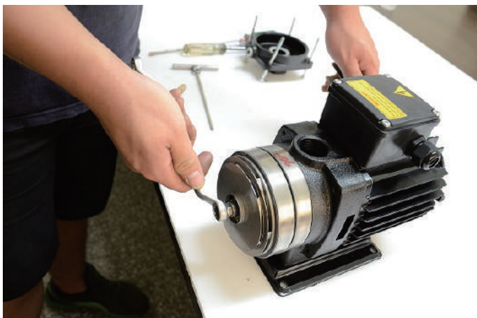
6. lépés: szorítsa meg az univerzális fogófejeket, használjon csavarkulcsot, hogy kivegye a záróanyát
