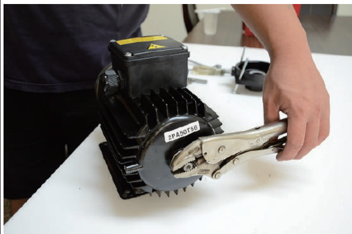
8. lépés: használjon univerzális fogót a motororsó végének megfogásához
